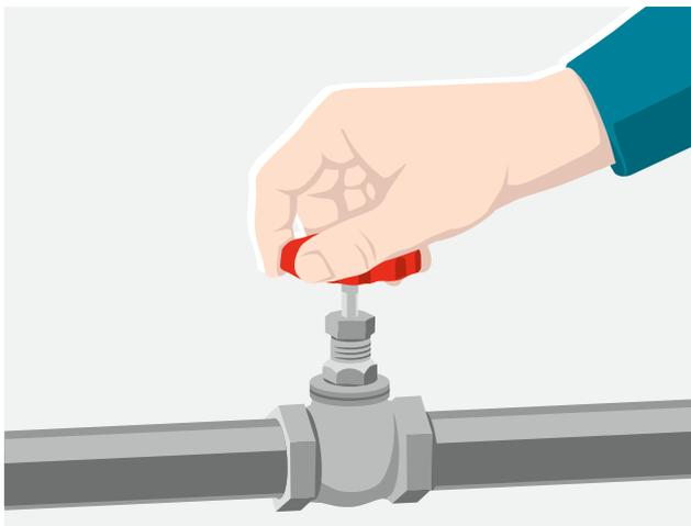
1 Chiudere tutti i dispositivi di bloccaggio accessibili per interrompere il flusso del gas.
