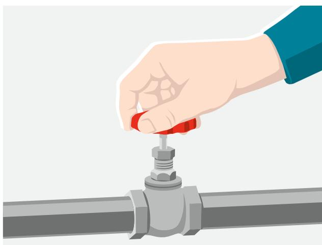
1 Se possibile, chiudere i dispositivi di bloccaggio per impedire la fuoriuscita del gas.
